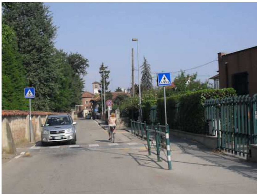
Esempio serie di barriere sfalsate a protezione di una scuola
