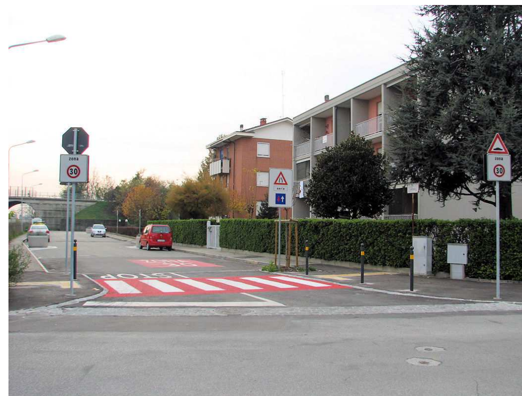
DOPO: porta d'ingresso alla Zona 30 con collegamento marciapiedi rialzato
