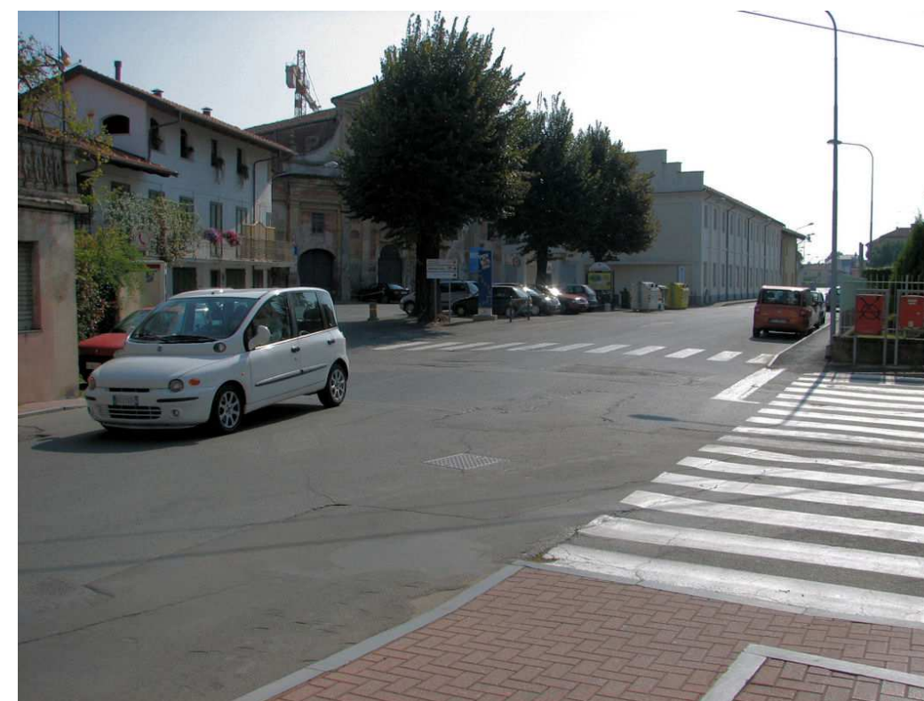
PRIMA: strada larga ed incrocio non protetto campo visivo ampio e monotono che invita a correre
