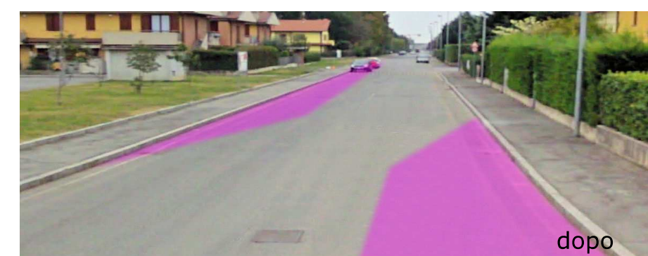
Via della Repubblica l'arteria deve essere risistemata con la sosta alternata destra/sinistra in modo da creare continue chicane di rallentamento
