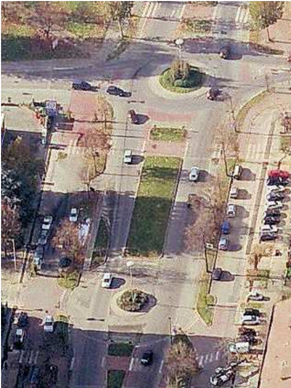
Esempi di misure puntuali (rotonda, minirotonda, spartitraffico) utili a mantenere i 50km/h su un'asta urbana
