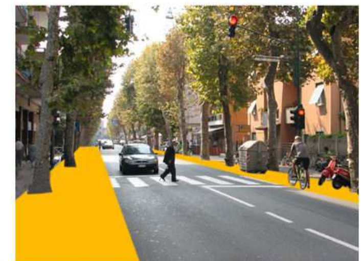
Proposta avanzamento marciapiedi (carreggiata utile: larghezza = 6,00 m) Esempio di confronto prima/dopo su viale urbano in Liguria
