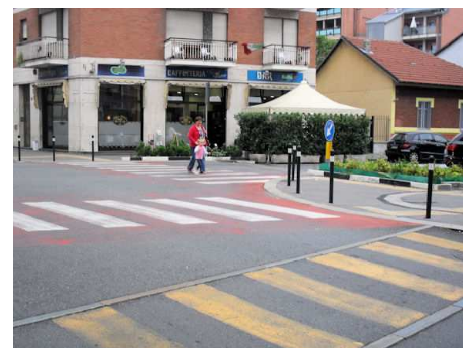
ADESSO: l'incrocio risolto con una piattaforma rialzata "filtrante"
