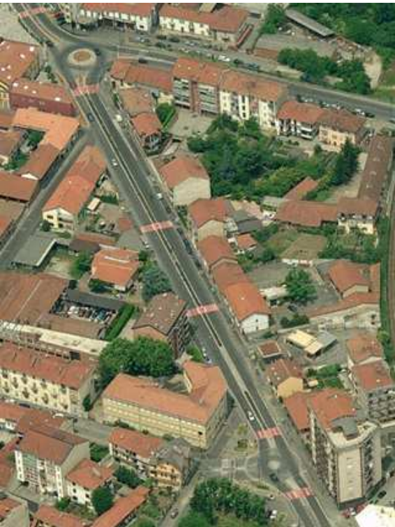
Esempi di misure puntuali (rotonda, minirotonda, spartitraffico) utili a mantenere i 50km/h su un'asta urbana
