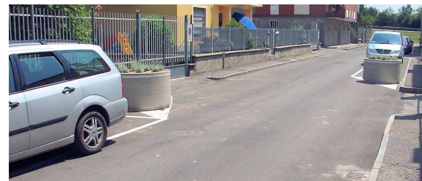
Esempio di sosta alternata con chicane intermedia
